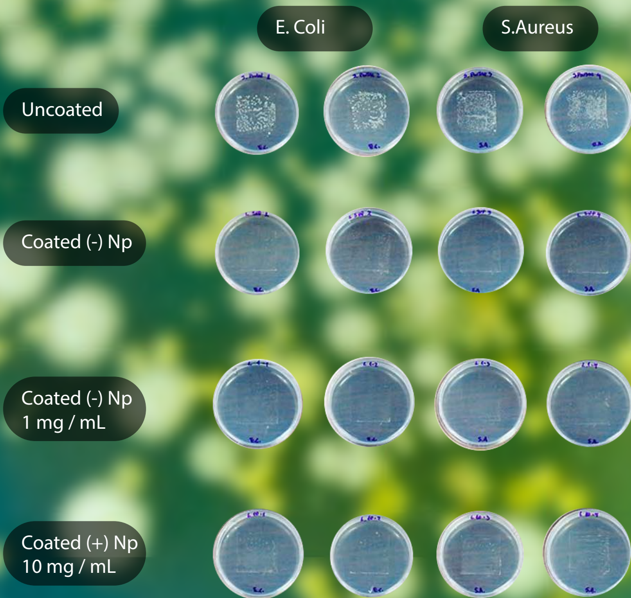
Figura 1. Ensayo de impresión sobre agar de superficies pintadas con Látex. Se imprimieron sobre agar LB, superficie no pintada, pintada con látex sin nanopartículas de cobre, pintada con látex + 1 mg/mL de nanopartículas de cobre y látex + 10 mg/mL nanopartículas de cobre, previamente inoculadas con 1 millón de UFC de E. coli y S. aureus. Para cada tratamiento n = 2.
